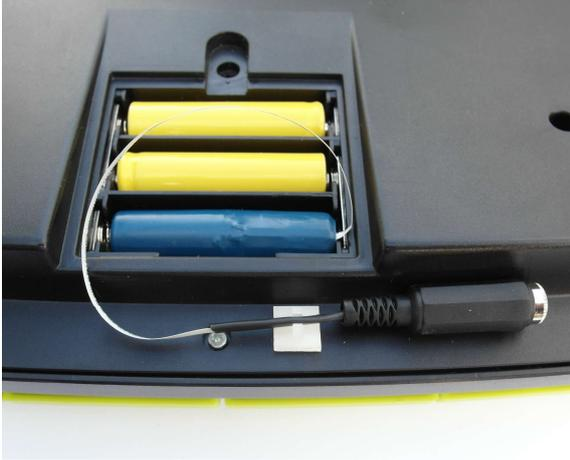
Legen Sie den Netzteil Adapter (blau) in ein geeignetes Batteriefach ein und **achten Sie dabei auf die korrekte Polung:**
