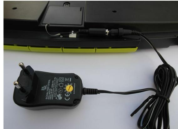
Zuletzt verbinden Sie das Netzteil mit der Buchse am Netzteil-Adapter. Achten Sie später darauf das dünne Kabel des Netzteil-Adapters nicht zu stark zu belasten.
