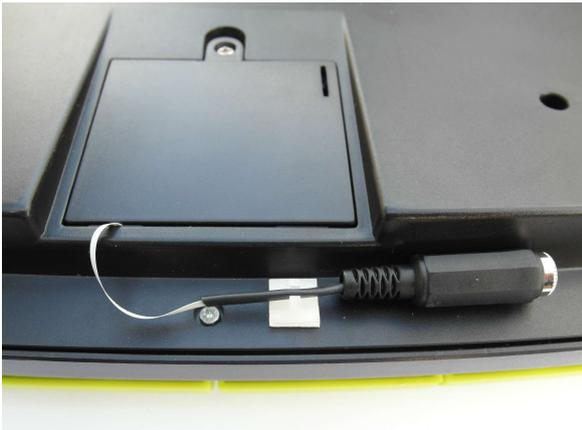
Verlegen Sie nun das Kabel so, wie Sie es wünschen und schließen Sie vorsichtig das Batteriefach. Achten Sie dabei darauf das Kabel nicht zu knicken – kleine Radien von bis zu ca. 1mm sind zulässig.
